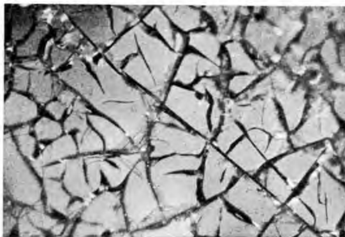
23-5. ábra. YM gyantarendszer felülete 1000 órás öregítés után (420-szoros nagyítás)
