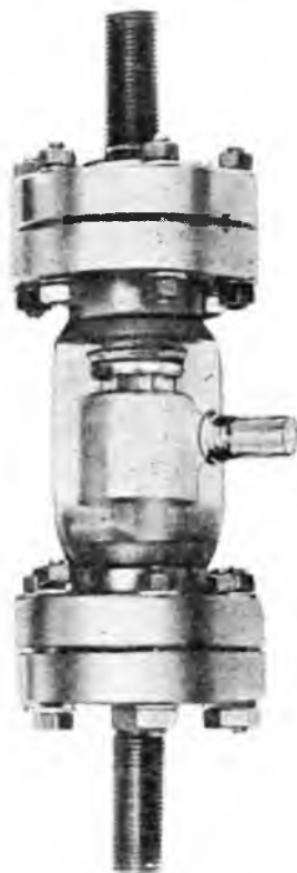
21-1. ábra. Többszöri méréshez felhasználható 400 °C-ig kályházható kivitelű, bontható vákuum-ívoltókamra
