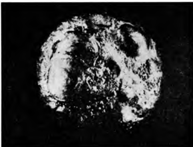
20-2. ábra. Az ív eróziós hatása vákuum- és légkapcsoló érintkezőjének felületén 100 ezer kikapcsolás után a) vákuumkapcsoló érintkezője; b) légkapcsoló érintkezője
