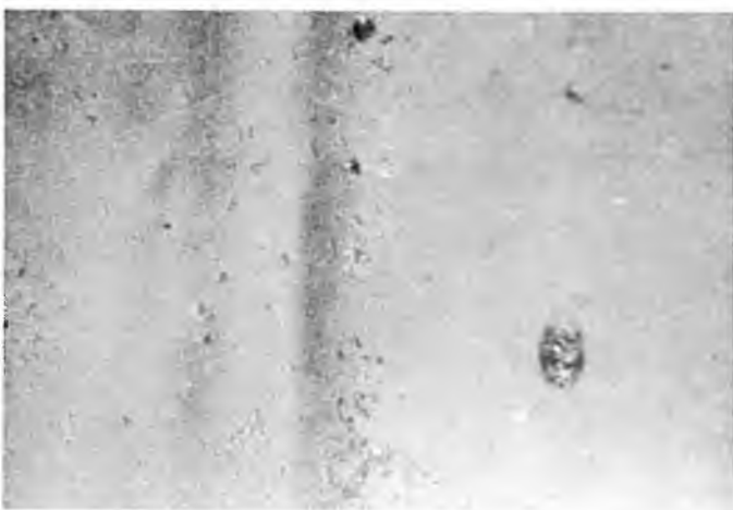
23-7. ábra. XH gyantarendszer felülete 2000 órás öregítés után (420-szoros nagyítás)
