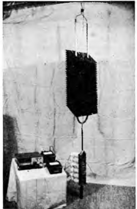
14-5. ábra. Hatférőhelyes, kétágú hőcső mérési összeállítása
