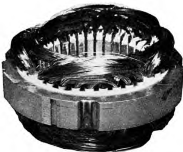
22-10. ábra. Homlok- és horonyszigeteléssel ellátott huzalozott állórész
