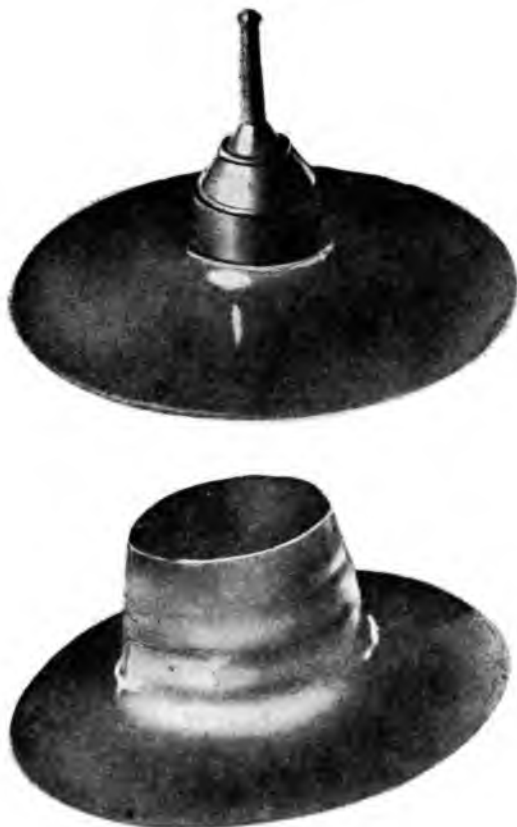
26-3. ábra. Zsugorítható esőterelő tányér a) fröccsöntés után; b) tágítás után
