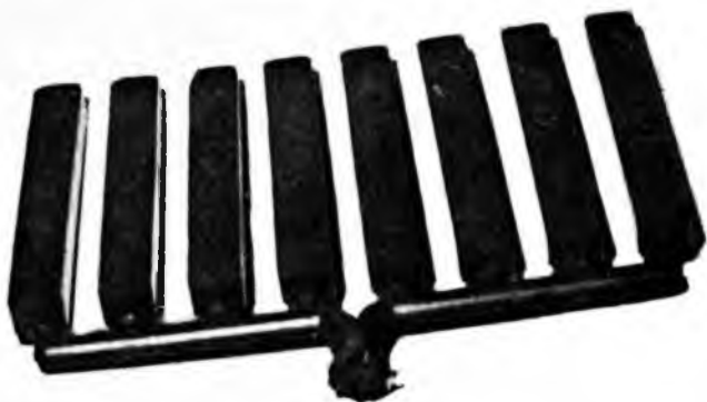
24-3. ábra. VET 300 típusú géppel fröccsöntött rúd alakú próbatestek
