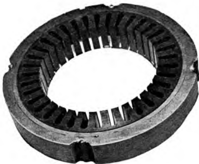
22-9. ábra. Homlok- és horonyszigeteléssel ellátott állórész
