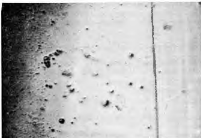
23-2. ábra. BP gyantarendszer felülete az öregítés megkezdése előtt (420-szoros nagyítás)
