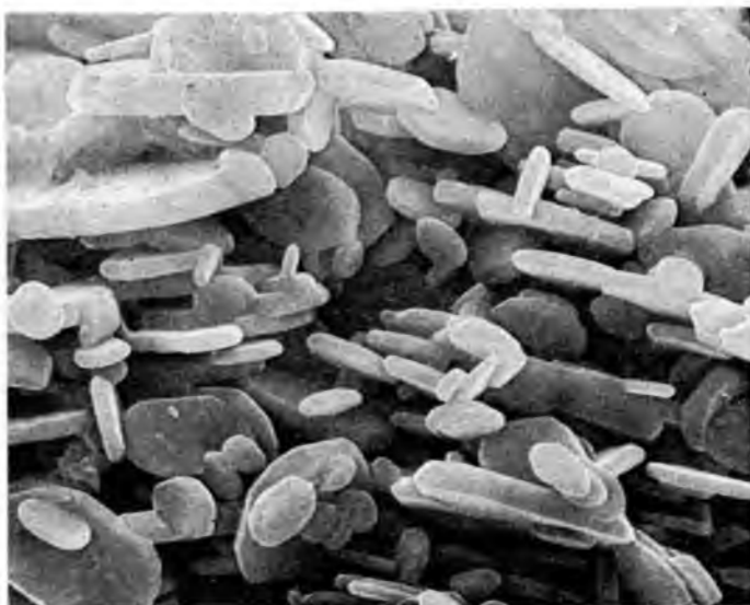
27-2. ábra. Öröletlen T1 \alpha -S timföld SEM felvétele N = 3300 \times
