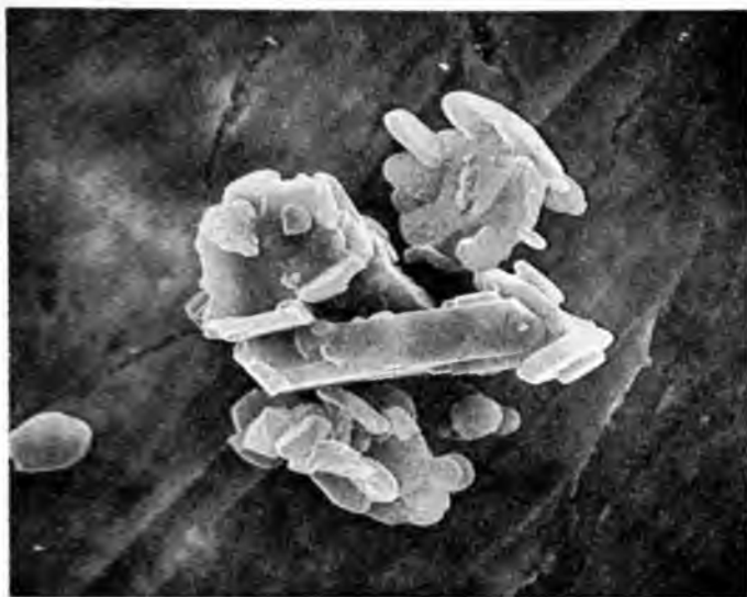
27-4. ábra. 40 órát őrölt T1 \alpha -S tímfd SEM felvétele N = 3300 \times
