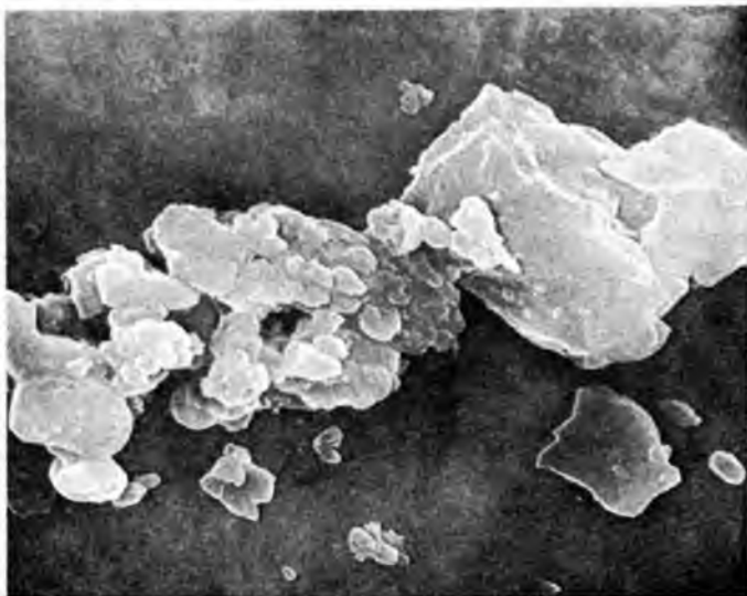
27-6. ábra. 72 órát őrölt T1 \alpha -S timföld SEM felvétele N = 6600 \times
