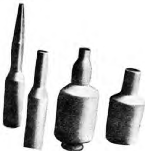
26-4. ábra. Zsugorítható kábelvégelező fröccsöntés után; tágitás előtt; tágitás után és szerelésre kész állapotban
